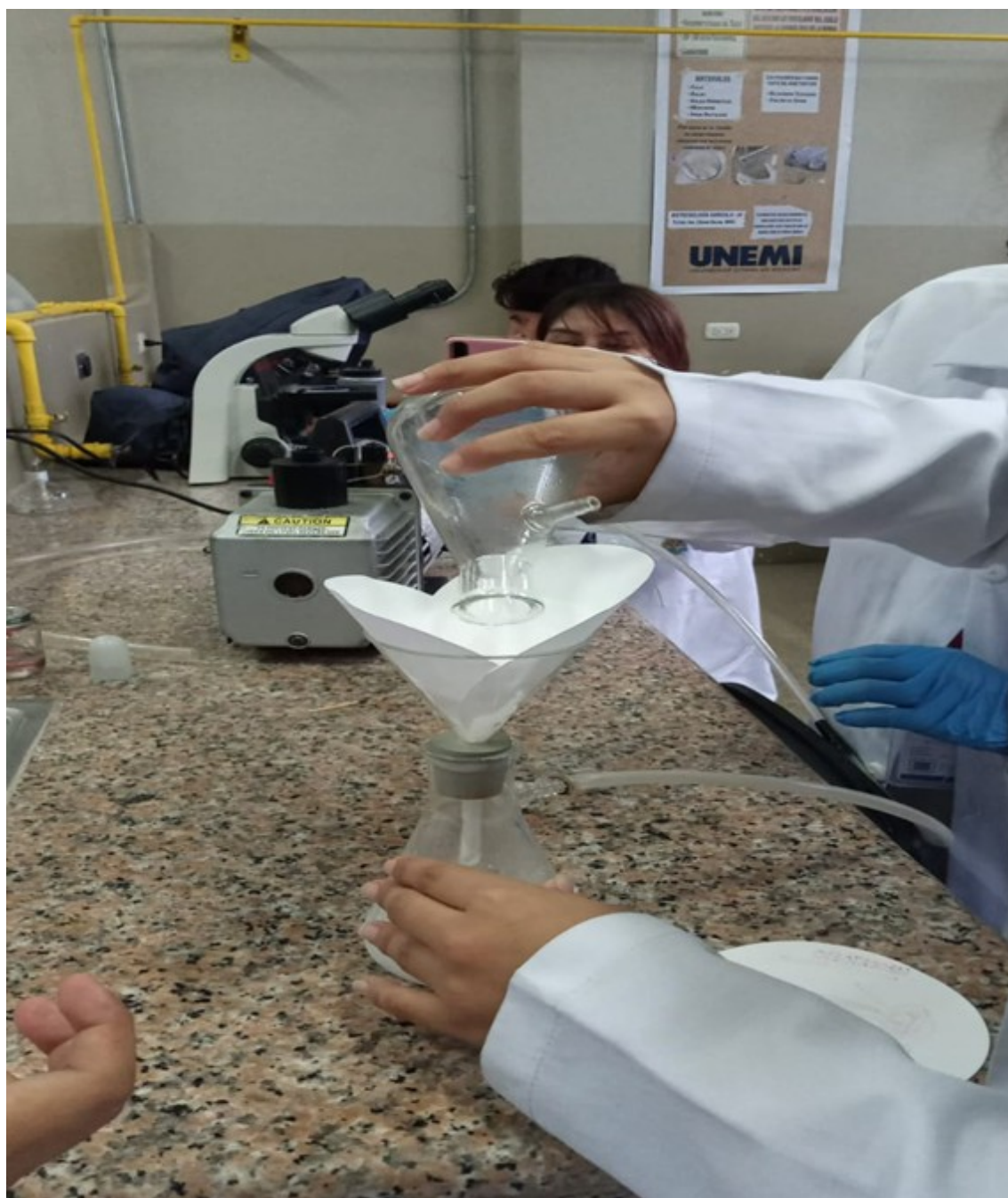
Figura B.1: Filtración de sulfato de aluminio
